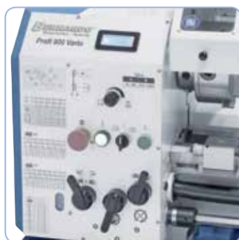
Plynulá regulace otáček vřetena s digitálním ukazatelem
