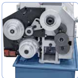
Výměnná kola na řezání závitů jsou součástí základní výbavy
