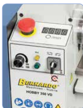
Plynulá regulace otáček vřetena s digitálním ukazatelem
