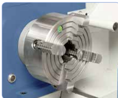
4čelistové nesoustředné skličidlo 200 mm (standardně), ideální k upnutí asymetrických obrobků
