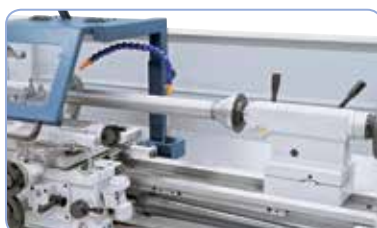
Středící hrot pr. 100 mm, ideální k upínání trubek a dutých těles (na objednávku)
