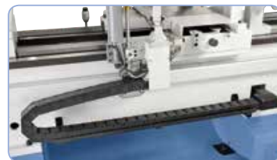
Včetně uložení kabelu v energetickém řetězu
