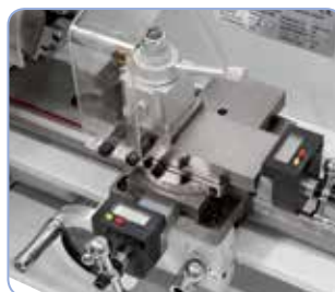
Pro hospodárnou práci je stroj sériově vybaven rychloupínacím nožovým držákem
