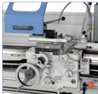
Délkový a příčný pohyb suportu, popřípadě horního suportu, zajišťuje 42 přímo volitelných posuvů
