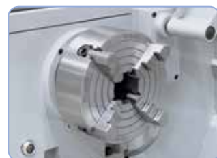
4čelistové nesoustředné sklíčidlo pr. 200 mm k upnutí nesoustředných obrobků (na objednávku).
