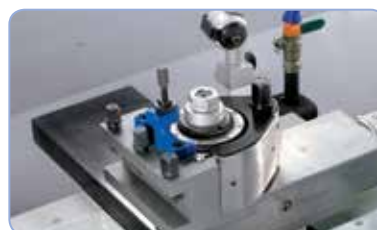
Rychloupínací nožový držák Multifix umožňuje snížení vedlejších výrobních časů a zaručuje vysokou opakovanou přesnost obrábění
