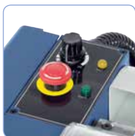
Plynulá regulace otáček hlavního vřetena pomocí potenciometru
