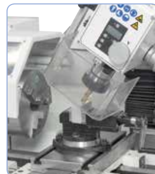
Naklápěcí frézovací hlava poskytuje všestranné možnosti využití
