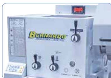
Jednoduché ovládání, všechny ovládací a obslužné prvky jsou přehledně umístěné na hlavě převodovky
