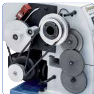
Rychlá a jednoduchá změna otáček pomocí klínového řemenu
