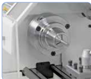
Na objednávku: kleštinový upínač 5C, rozsah upnutí 3 – 26 mm
