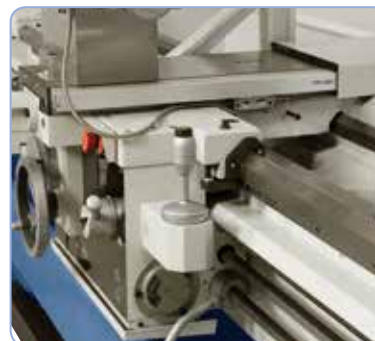
Včetně podélného a příčného rychloposuvu
