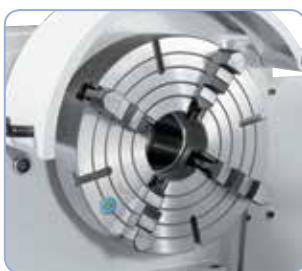
4čelistové nesoustředné sklíčidlo pr. 400 mm k upnutí nesoustředných obrobků (na objednávku).
