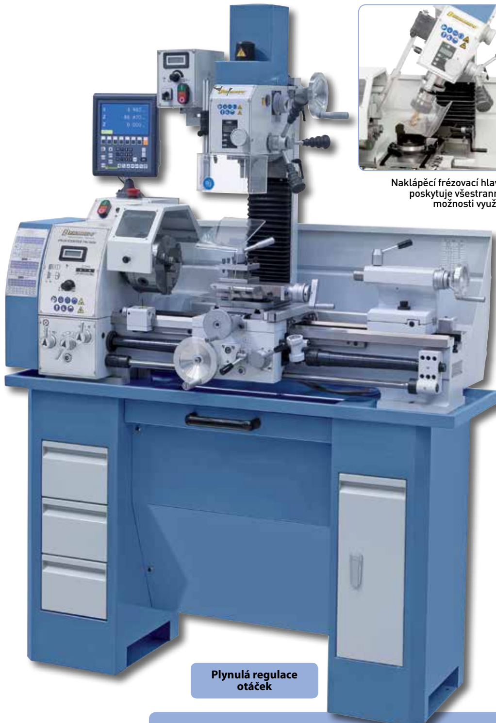
Suport se jemně ladí pomocí ručních kol, tento model je navíc vybavený automatickým příčným posuvem
