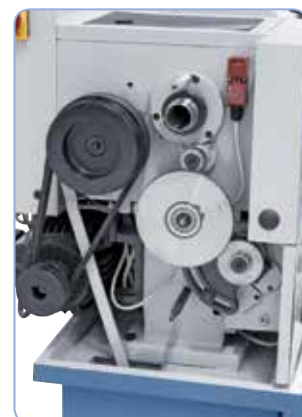
Výměnná kola pro řezání závitů v základní výbavě
