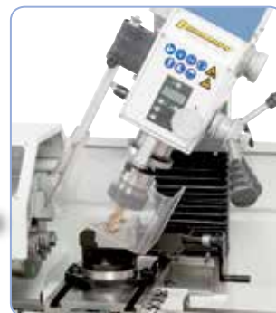
Naklápěcí frézovací hlava poskytuje všestranné možnosti využití
