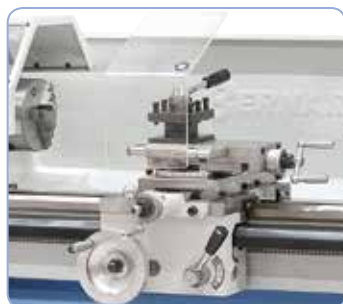
Lehké a přesné vedení suportu má dlouhou životnost, vedení lze seřizovat klínovými podložkami
