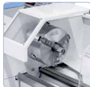
3čelistové sklíčidlo 125 mm s vnitřními a vnějšími čelistmi v základní výbavě
