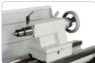
Robustní koník s kuželem MK 4 lze přestavit pro soustružení kuželů.
