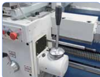
Sériově vybavený rychloposuvem pro snížení vedlejších výrobních časů
