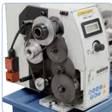
Výměnná kola pro řezání závitů v základní výbavě
