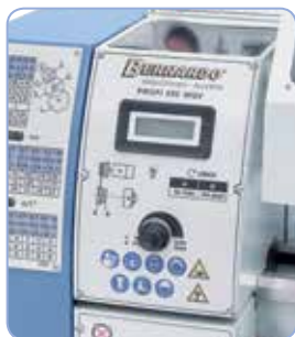
Plynulá regulace otáček vřetena s digitálním ukazatelem
