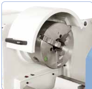
Výhoda sklíčidla Bernardo PS3-250 mm / D8: k dodání čelisti monoblokové, základní, reverzní a výměnné
