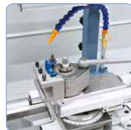
Zrychlení výměn nožů lze dosáhnout rychlovýměnným nožovým držákem
