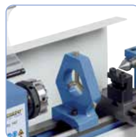
Pevná luneta s bronzovým vedením (Obj. č. 03-1535)
