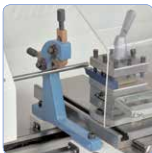
Posuvná luneta pro opracování tenkých hřídelí
