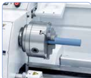
3čelistové ocelové sklíčadlo s vnitřními a vnějšími čelistmi v základní výbavě
