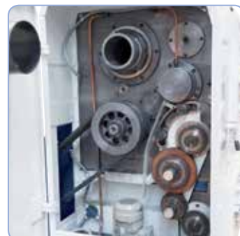
Tvrzené hlavní vřeteno se 130 mm vrtem vřetena, uložené na kuželíkových ložiscích a radiálních válečkových ložiscích.
