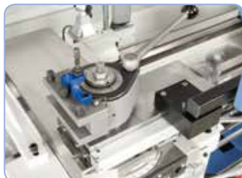
Pro hospodárnou práci je stroj vybavený rychloupínacím nožovým držákem.
