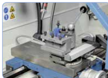
Rychloupínací nožový držák Multifix v základní výbavě (Standard 165 Top)
