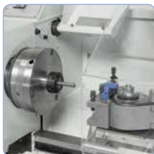
Na objednávku: rychloupínací nožový držák Multifix a kleštinový upínací ER 25
