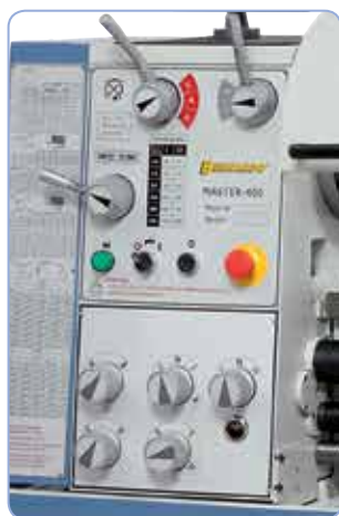
Přehledně umístěné ovládací prvky na převodové skříní s kalenými a broušenými ozubenými koly, která zajišťují klidný a tichý chod
