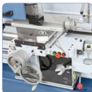
Sériově dodávaný s rychloposuvem pro snížení vedlejších výrobních časů
