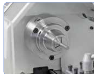
Na objednávku: kleštinový upínač 5C, rozsah upnutí 3 - 26 mm
