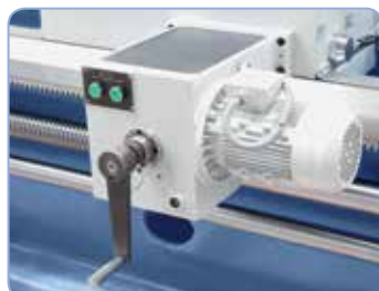
Motoricky stavitelný koník (od vzdálenosti hrotů 3000 mm)
