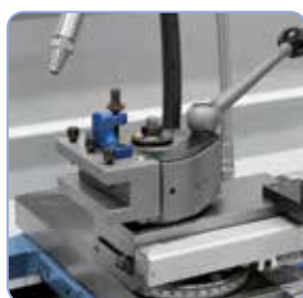
Pro hospodárnou práci je stroj sériově vybaven rychloupínacím nožovým držákem. (Standard 165 V-Top).
