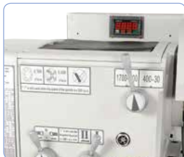
Plynulá regulace otáček vřetena s digitálním ukazatelem
