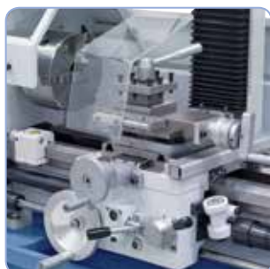
Suport se jemně ladí pomocí ručních kol, tento model je navíc vybavený automatickým příčným posuvem
