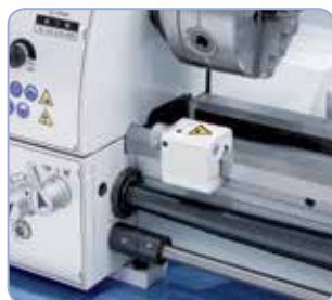
Stroj 700 PRO je nově dodáván s kluznou spojkou a podélným mikrometrickým dorazem
