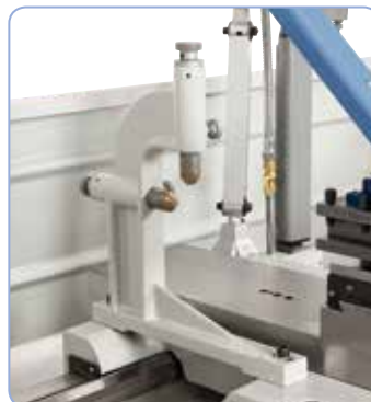
Posuvná luneta pro opracování tenkých hřídelí.
