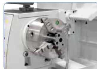
Centricky upínané 4čelistové sklíčidlo 200 mm, optimální pro čtyřhranné obrobky (na objednávku)
