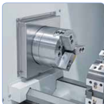
Hydraulické tříčelistové sklíčidlo prům. 160 mm
