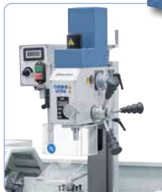
Frézovací nástavec FA 16 lze dodat na objednávku - technické údaje u Proficenter 550 WQV
