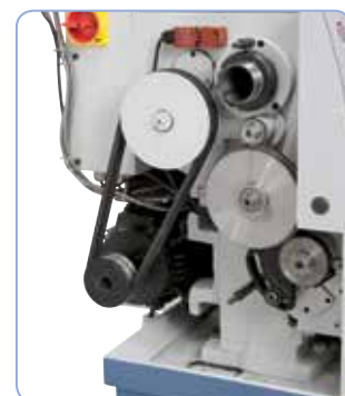
Dodáváno s kompletní sadou výměnných kol pro řezání závitů
