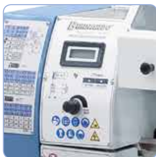
Plynulá regulace otáček vřetena s digitálním ukazatelem.
