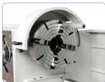
4čelistové nesoustředné sklíčidlo pr.400 mm k upnutí nesoustředných obrobků (na objednávku).
