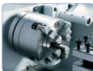
4-čelistové sklíčadlo pr. 100 mm k upínání obrobků nepravidelného tvaru (na objednávku)
