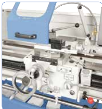
Délkový a příčný pohyb suportu, popřípadě horního suportu, zajišťuje 42 přímo volitelných posuvů
