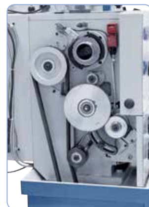
Výměnná kola pro řezání závitů v základní výbavě
