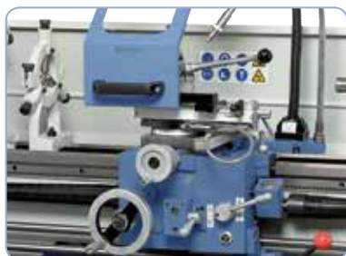
Snadný chod nožového suportu a čt yřnožového držáku pomocí ruční kola s nastavitelnou jemnou stupnicí
