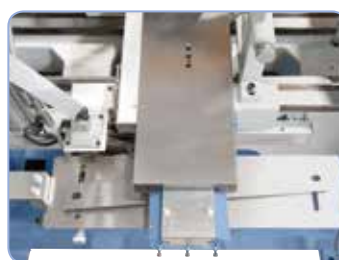
Zařízení pro soustružení kuželů lze dodat na objednávku, délka soustružení 455 mm, úhel nastavení \pm 8^\circ
