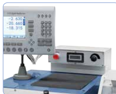
Plynulá regulace otáček vřetena s digitálním ukazatelem.
