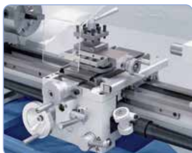
Vhodné umístění ovládací páky strojního podélného a příčného posuvu
