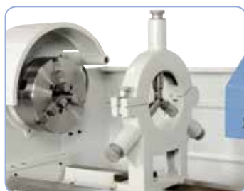
Pevná luneta ke stabilizaci dlouhých obrobků
