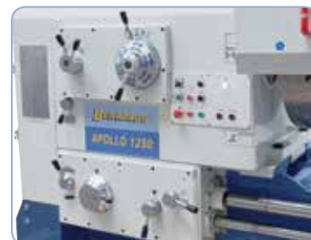
Přehledně umístěné ovládací prvky na převodové skříni s kalenými a broušenými ozubenými koly, která zajišťují klidný a tichý chod
