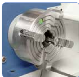
4čelistové nesoustředné sklíčidlo 200 mm s reverzními čelistmi
