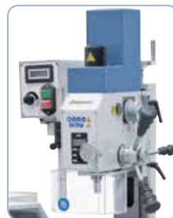
Frézovací nástavec FA 16 lze dodat na objednávku. (kromě Profi 550 WQV vč. dig. odměřování)
