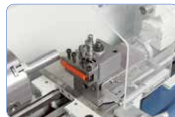
Zrychlení výměn nožů lze dosáhnout rychlovýměnným nožovým držákem Bernardo vel.10 (na objednávku).
