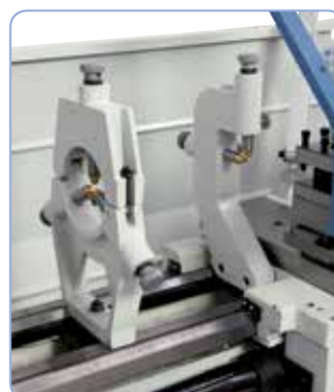
Rychloupínací nožový držák Multifix umožňuje snížení vedlejších výrobních časů a zaručuje vysokou opakovanou přesnost obrábění
