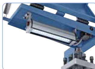
Integrovaná LED lampa v ochranném krytu pro optimální osvětlení při práci.
