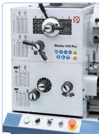
Lehký chod posuvu a regulace otáček, kalená a broušená ozubená kola běžící v olejové lázni v převodovce zajišťují klidný chod stroje
