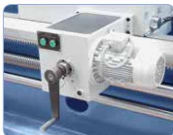
Motorický stavitelný koník (od vzdálenosti hrotů 3000 mm)
