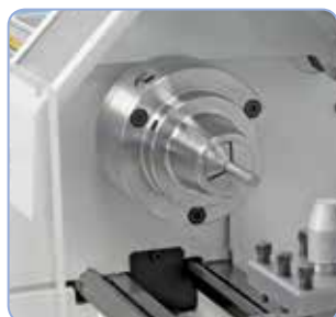
Na objednávku: kleštinový upínač 5C, rozsah upnutí 3 - 26 mm
