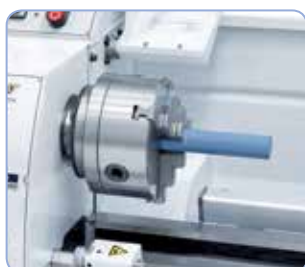
Pro práce s dlouhým materiálem je soustruh vybaven průchodem vřetena s průměrem do 38 mm.
