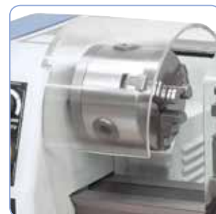
3čelistové sklíčidlo pr. 80 mm s ochranným krytem dle normy CE
