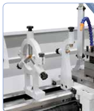
Sériově dodávaná pevná, popřípadě pohyblivá luneta k stabilizaci dlouhých obrobků
