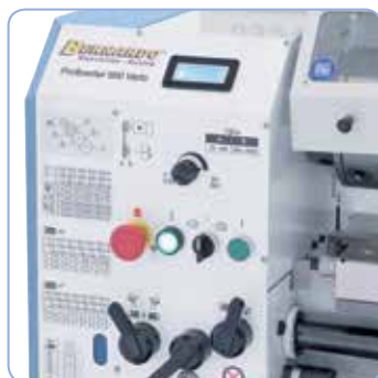
Plynulá regulace otáček vřetena s digitálním ukazatelem
