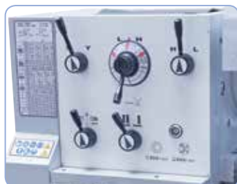
Jednoduché ovládání, všechny ovládací a obslužné prvky přehledně umístěné na hlavě převodovky
