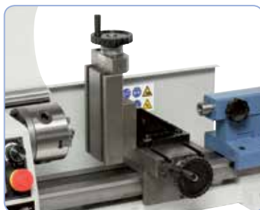
Vertikální frézovací suport s upínací plochou 64 x 130 mm (na objednávku)
