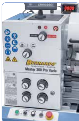
Přehledně umístěné ovládací prvky na převodové skříni s kalenými a broušenými ozubenými koly, která zajišťují klidný a tichý chod
