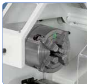
4čelistové nesoustředné sklíčidlo k upínání obrobků nepravidelného tvaru (na objednávku).
