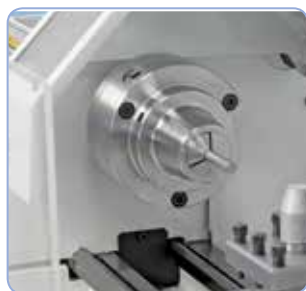
Na objednávku: kleštinový upínáč 5C, rozsah upnutí 3 - 26 mm
