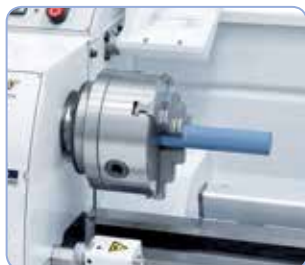
Pro práce s dlouhým materiálem je soustruh vybaven průchodem vřetena s průměrem do 38 mm (700 Top)
