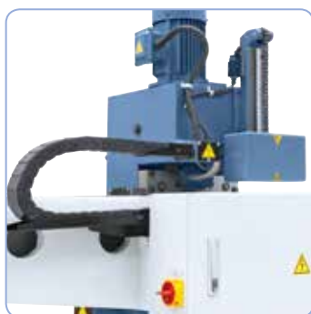
Pinola s protizávažím a kabeláž v energetickém řetězu na zadní straně vrtací hlavy
