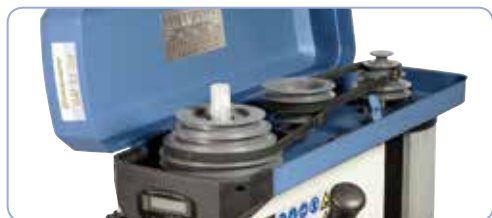
Kvalitní klínové řemeny zajišťují optimální přenos výkonu
