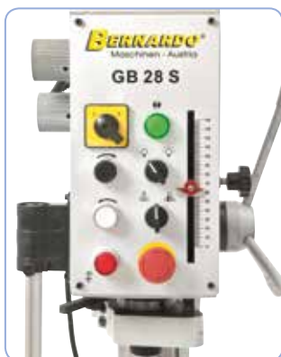
Jednoduchá obsluha ovládacích prvků pro změnu otáček
