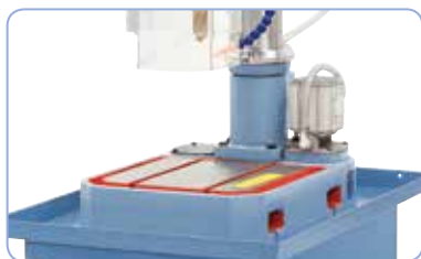
Jednoduché nastavení výšky vrtací hlavy klikou
