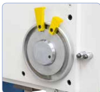
Zařízení pro řezání závitů s reverzací směru otáčení, ideální pro sériovou výrobu (na KBM 50).
