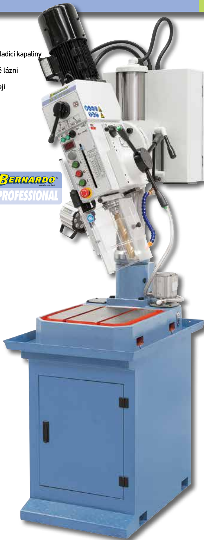
Jednoduché nastavení převodových stupňů. Potenciometr lze nastavit požadovanou výši otáček
