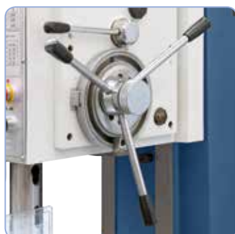
Hvězdicová rukojeť k ručnímu posuvu pinoly, spojková páka pro automatický posuv.
