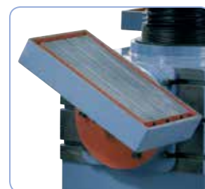
Naklápěcí vodorovný stůl v úhlu od -50° do +50° rozšiřuje oblast využití (na objednávku)
