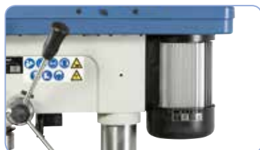
Výkonný hliníkový motor s krytím IP 54
