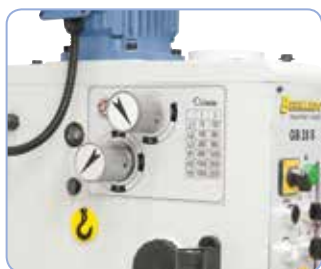
Jednoduchá obsluha ovládacích prvků pro změnu otáček
