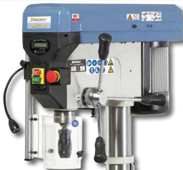
Digitální zobrazení hloubky vrtání zjednodušuje obsluhu
