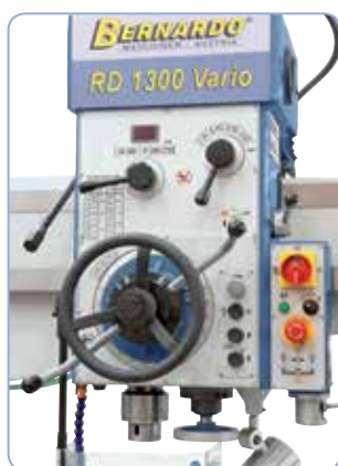
Jednoduché nastavení rozsahu posuvu a otáček na vrtací hlavě
