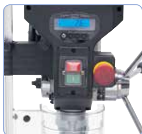
Hlavní vypínač s krytím IP 54 a samostatný nouzový vypínač dle normy CE
