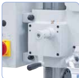
Jednoduché nastavení výšky vrtací hlavy klikou
