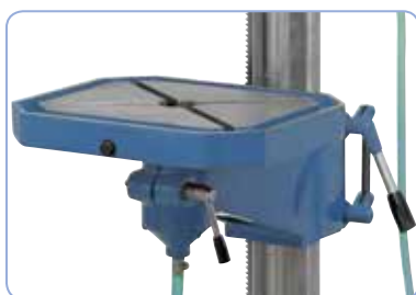
Masivní ručně zaškrabaný pracovní stůl s T-drážkami
