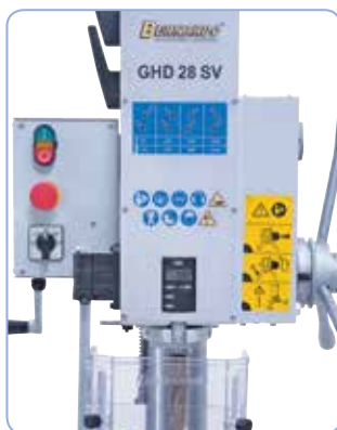
Pohyb pinoly je možný ručně nebo pomocí strojního posuvu
