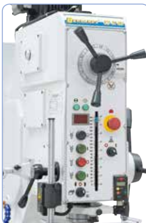
Pohodlné motorické nastavení výšky stolu
