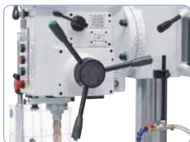
Sériově vybavená automatickým 3 stupňovým posuvem vřetena
