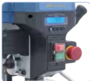
Sériově vybavená digitálním displejem otáček a hloubky vrtání
