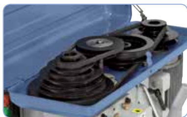
Použitím vyvážených řemenic je zajištěn velmi klidný chod
