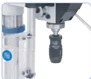
Sériově vybavená rychloupínací sklíčidlem 1 - 16 mm
