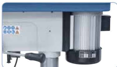
Výkonný hliníkový motor s krytím IP 54
