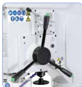
Masivní otočný a naklápěcí úhlový stůl nabízí univerzální možnosti upnutí
