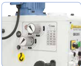
Jednoduchá obsluha ovládacích prvků pro změnu otáček
