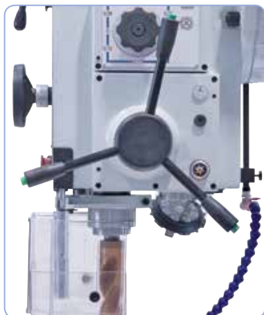
Elektromagnetickou spojkou lze zapínat 6 automatických posuvů vřetena
