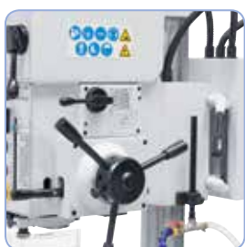
Sériově vybavená 3 automatickými posuvy vřetene
