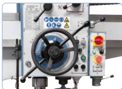
Vřeteno může pojíždět 3 způsoby: rychloposuv ruční pákou, jemný posuv ručním kolem nebo automatickým posuvem
