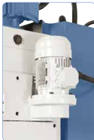
Motor posuvu snižuje polohovací doby pinoly
