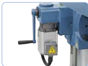
Pohodlné motorické nastavení výšky stolu
