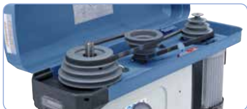
Kvalitní klínové řemeny zajišťují optimální přenos výkonu
