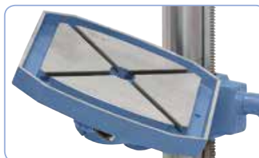
Pracovní stůl otočný o 360° je vhodný pro souřadnicové vrtání
