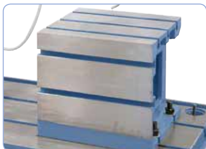
Sériově je součástí dodávky přesně broušená upínací kostka s 5ti T-drážkami
