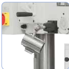
LED pracovní osvětlení na stroji zajišťuje optimální světlo
