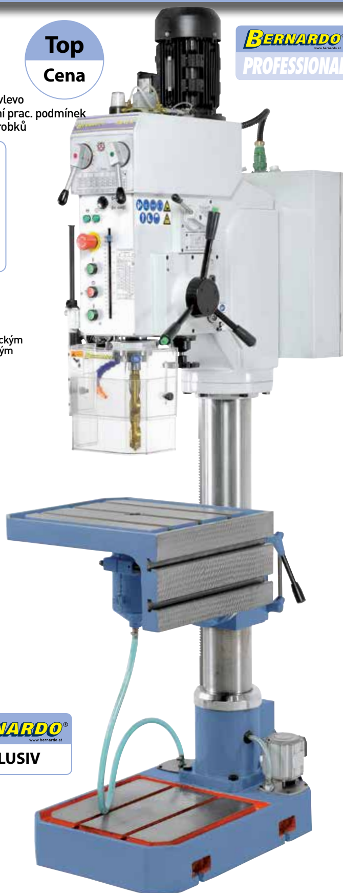
Masivní otočný a naklápěcí úhlový stůl nabízí univerzální možnosti upnutí
