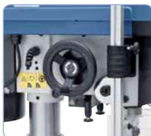
Ruční kolo pro nastavení požadovaných otáček, umístěné na boční straně
