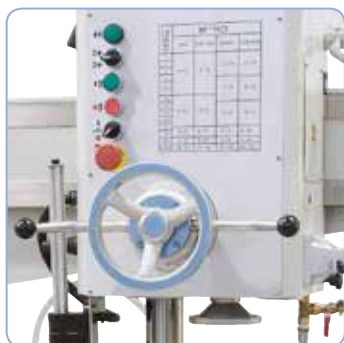
Všechny ovládací a kontrolní prvky jsou umístěné přehledně na vřeteníku
