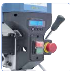
Digitální zobrazení hloubky vrtání zjednodušuje obsluhu
