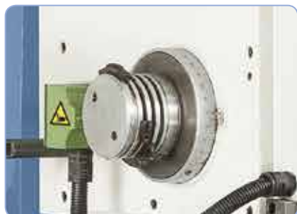
Zařízení pro řezání závitů s rychloposuvem, popřípadě pracovním posuvem, a rychlý zpětný chod (z KBM 63)
