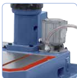
Ručně zaškrabaná základová deska, sériově dodávaná s integrovaným čerpadlem chladicí kapaliny.
