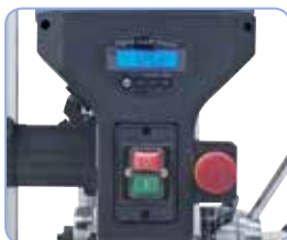
Digitální zobrazení hloubky vrtání zjednodušuje obsluhu
