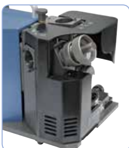
Broušení úhlu podbroušení u 2břítých fréz
