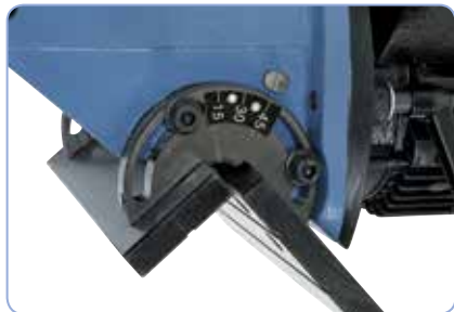
Plynulé nastavení úhlu zkosení hrany od 15° do 45°
