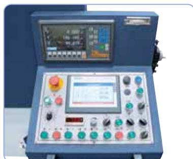
Včetně Siemens SMART-panel IE V3 s dotykovou obrazovkou a elektronické ruční kolo
