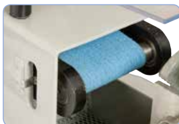
Nastavení výšky brusného válce pro broušení mimo střed
