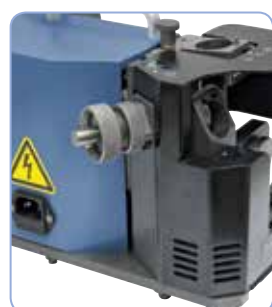
Broušení úhlu podbroušení u 3 a 4břítých fréz
