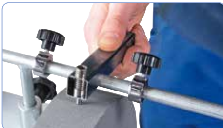
05-2058: Diamantový orovňavač kotoučů ke kruhovému a přímému orovňávání brusného kotouče
