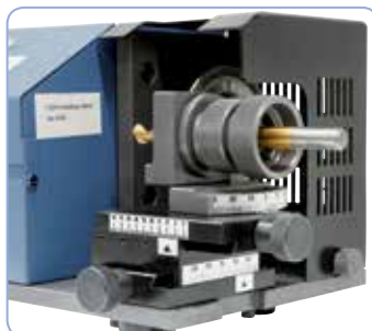
Nastavitelný vrcholový úhel od -30° do +30°
