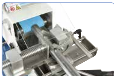
Kombinovaný svěrák pro upnutí trubek a profilů
