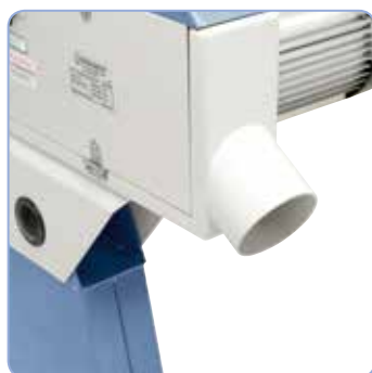
Sériově vybavená hrdlem odsávání prům. 100 mm
