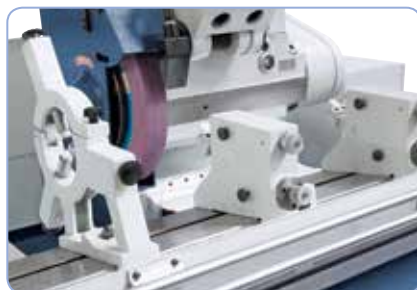
Sériově vybavená jednou pevnou, popřípadě 2 otevřenými lunetami pro stabilizaci dlouhých obrobků
