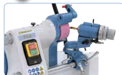
Přípravek pro upnutí vrtáku
