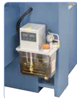
Centrální mazání všech vodicích drah a vřeten
