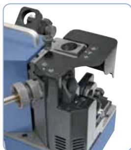
Broušení úhlu podbroušení u 3 a 4břítých fréz
