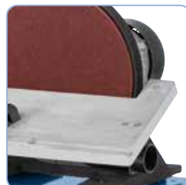
Sériově dodávána s namontovaným hrdlem odsávání pod brusným stolem, který je naklápěcí do úhlu 45°
