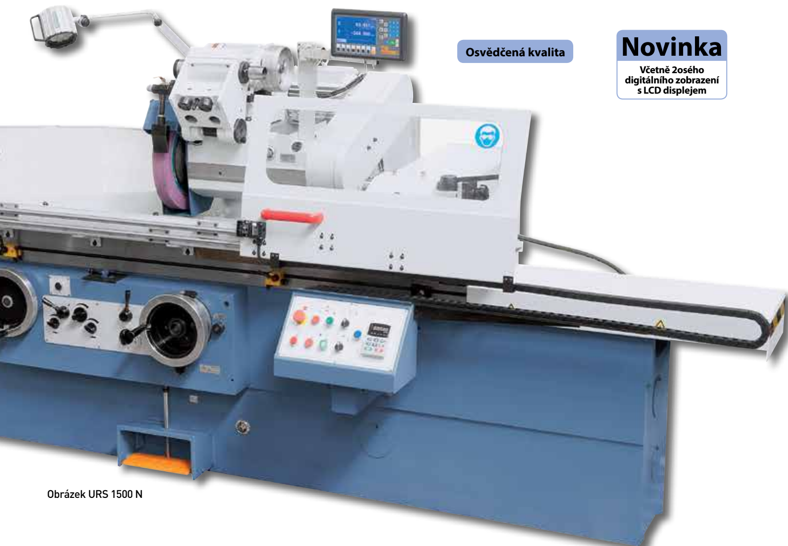
Sériově vybavená jednou pevnou, popřípadě 2 otevřenými lunetami pro stabilizaci dlouhých obrobků
