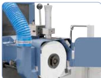
Součástí dodávky je paralelní orovnávací přípravek s mikrometrickým posuvem
