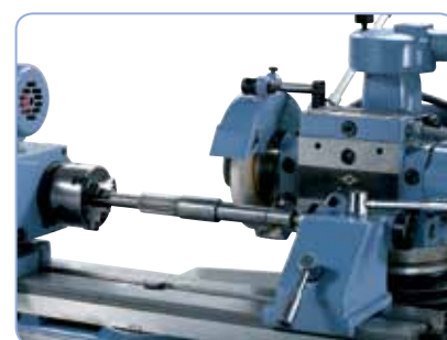
Vnější broušení válcových ploch
