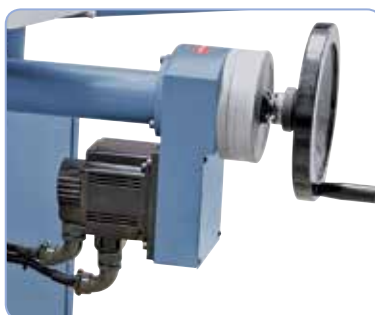
Servomotor zajišťuje automatické svislé pozicování s těmito funkcemi: rychloposuv vpřed - broušení - vyjiskření - rychloposuv zpět
