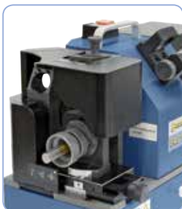
Broušení vrcholového úhlu
