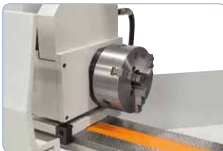
Robustní vřetenovou hlavu lze při broušení kuželů natáčet do úhlu max. 90°
