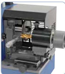
Broušení vnějšího spirálového břitu
