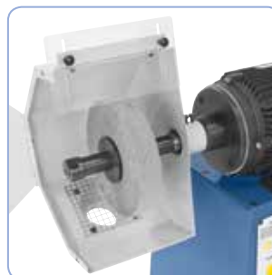
Otočný kryt kotouče s přípojkou pro odsávání
