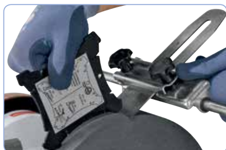
Jednoduché nastavení optimálního úhlu pomocí úhlové měrky WL-60 (součástí dodávky)
