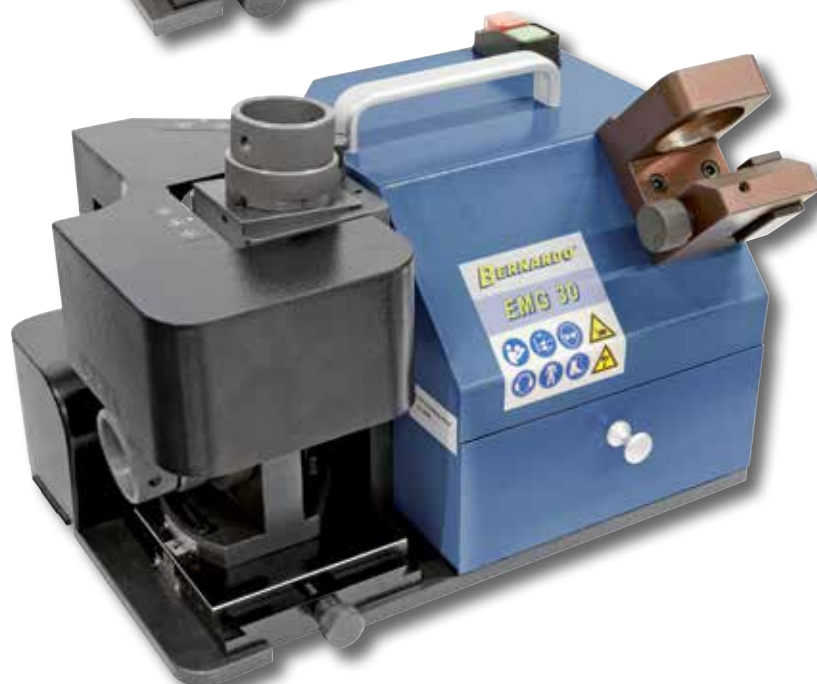
Broušení úhlu podbroušení u 2břítých fréz
