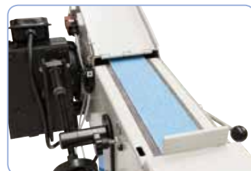
Plocha pro rovinné broušení 400 x 100 mm rozšiřuje oblast využití
