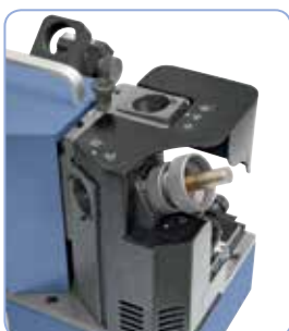
Broušení úhlu podbroušení u 2břítých fréz
