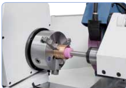
Sériově dodáváný s výklopným zařízením na vnitřní broušení
