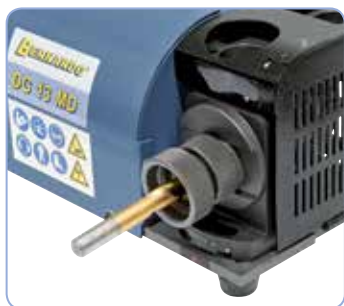
Broušení vrcholového úhlu
