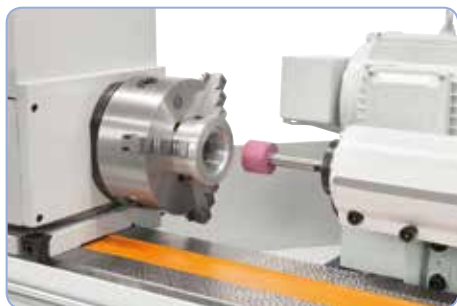
Sériově dodávána se zařízením na vnitřní broušení
