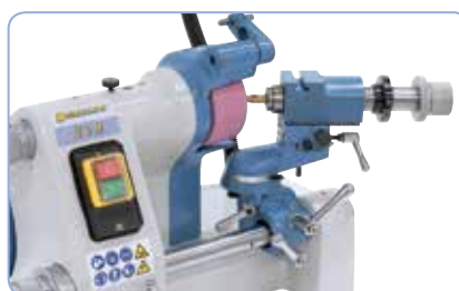
Přípravek pro upnutí stopkových fréz
