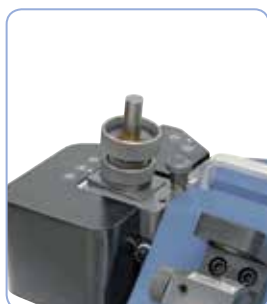
Broušení řezné hrany 1 a 3
