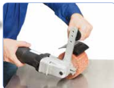
Vynikající kvalita povrchů při satínování, leštění, strukturování a matování
