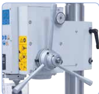
Pohyb pinoly je možný ručně nebo pomocí strojního posuvu
