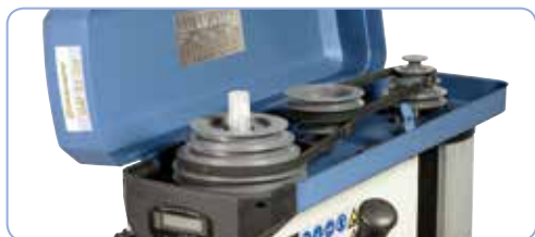
Kvalitní klínové řemeny zajišťují optimální přenos výkonu
