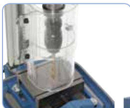
Sériově dodávaný laserový záměrný kříž zajišťuje přesnou práci
