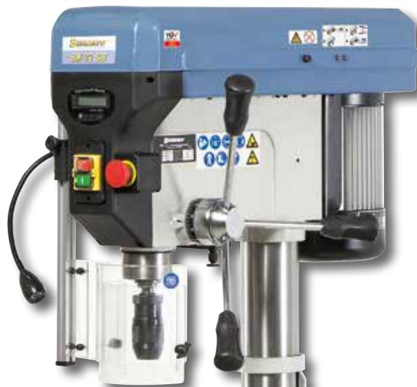
Digitální zobrazení hloubky vrtání zjednodušuje obsluhu
