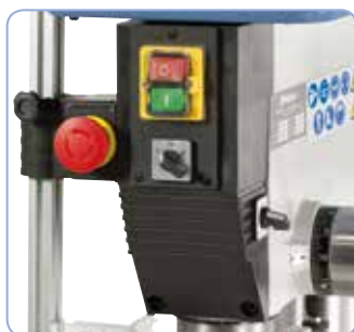
Samostatný nouzový vypínač, přepínač směru otáček a 2stupňový přepínač na přední straně stroje
