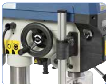
Ruční kolo pro nastavení požadovaných otáček, umístěné na boční straně
