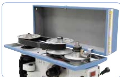
Přenos otáček motoru na vřeteno zajišťuje spolehlivý variátorový pohon
