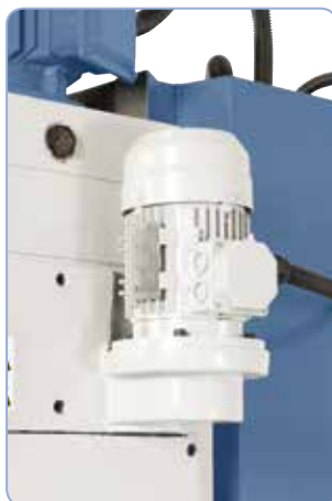
Motor posuvu snižuje polohovací doby pinoly
