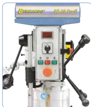
Sériově vybavená digitálním zobrazováním otáček. Ergonomicky umístěné ovládací a obslužné prvky na přední straně
