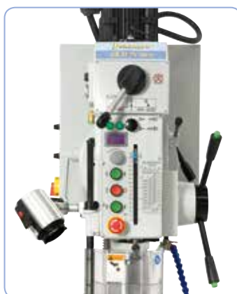
Jednoduché nastavení převodových stupňů. Potenciometr lze nastavit požadovanou výši otáček
