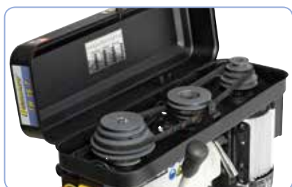
Vyvážené hnací řemenice poskytují velice klidný chod a vysoce kvalitní řemeny zajišťují optimální přenos výkonu
