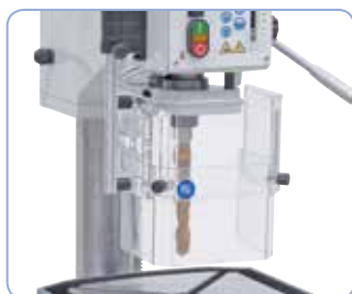
Ochranný kryt podle normy CE, stavitelný podle používaného vrtáku
