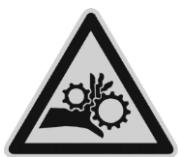
**Výstraha! Rotující díly.** Dbejte na to, abyste za žádných okolností nesahali na rotující obrobky nebo díly stroje a dejte pozor, aby rotujícími díly nemohly být zachyceny ozdobou nebo části oděvu. To je velké nebezpečí úrazu!
