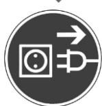
**Jestliže provádít údržbu, přezbrojení nebo čistící práce, odpojte stroj od sítě.** Než stroj znovu připojíte k proudovému okruhu, přesvědčte se, že je spínač ZAP/VYP v poloze „OFF“. Jestliže už stroj nebude používán, vytáhněte sítovou zástrčku.
