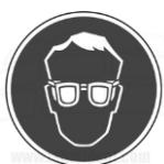
**Noste vhodné ochranné brýle.** Chraňte si oči, aby trásky nebo odletující úlomky nemohly způsobit poškození. Důsledkem nedodržení tohoto pokynu mohou být těžká zranění očí!
