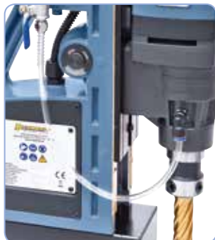
Automatické vnitřní mazání, chladicí kapalina je vedena přímo na špičku jádrového vrtáku
