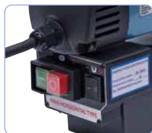
Uspořádání ovládacích prvků bez možnosti záměny na zadní straně stroje.
