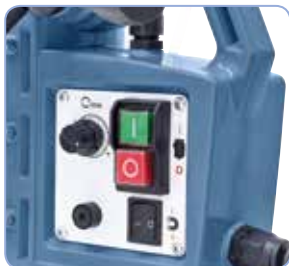
Přesné nastavení rychlosti řezu pomocí potenciometru.
