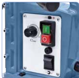
Přesné nastavení rychlosti řezu pomocí potenciometru.
