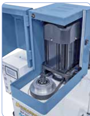
Použitím vyvážených řemenic je zajištěn velmi klidný chod
