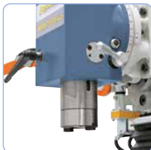
Masivní pinola (Ø 90 mm) zajišťuje vysokou stabilitu
