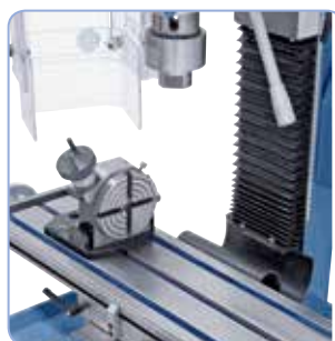
Otáčkový stůl umožňuje další využití stroje (stůl na objednávku)
