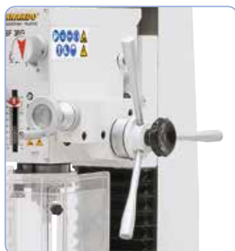
Jednoduché ovládání pinoly s vhodně umístěnými ručními ovladači, na ručních ovládacích kolech je stupnice k přesnému nastavení parametrů frézování.
