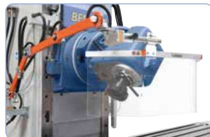
Univerzální frézovací hlava s 2mi osami otáčení s možností nastavení do téměř všech požadovaných pozic
