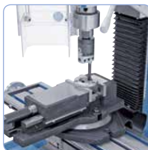
Stroj lze na objednávku vybavit vyvrtávací hlavou
