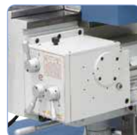
Přestavení stolu ve všech osách se provádí 8mi volitelnými posuvy včetně rychloposuvu
