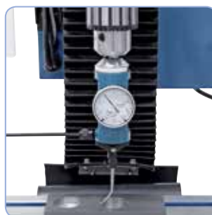
Středící 2D dotykový snímač k vyvrtávání
