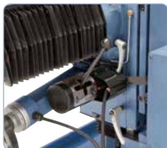
Volicí páka směru posuvu (na obrázku pro osu x a z), nastavení rychlosti posuvu potenciometrem na ovládacím panelu.
