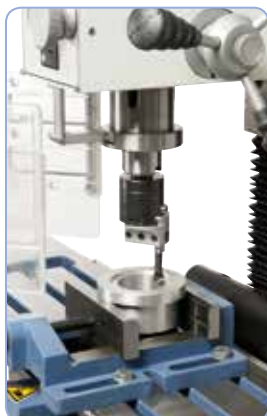
Stroj lze na objednávku vybavit vyvrtávací hlavou
