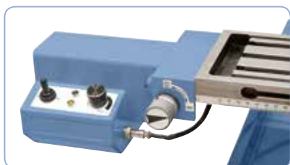
Plynule regulovatelný posuv frézovacího stolu (na objednávku) pro dosažení vyššího komfortu.
