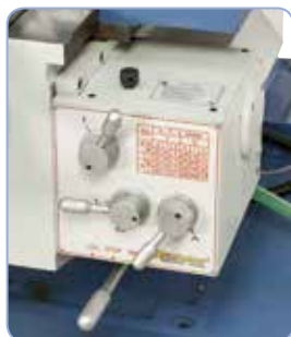
Využíváním posuvu stolu s funkcí rychloposuvu ve všech 3 osách lze podstatně snižovat ztráty času při výrobě
