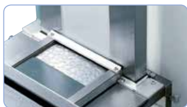
Masivní provedení vodících ploch v osách y, z zajišťuje zvýšenou stabilitu
