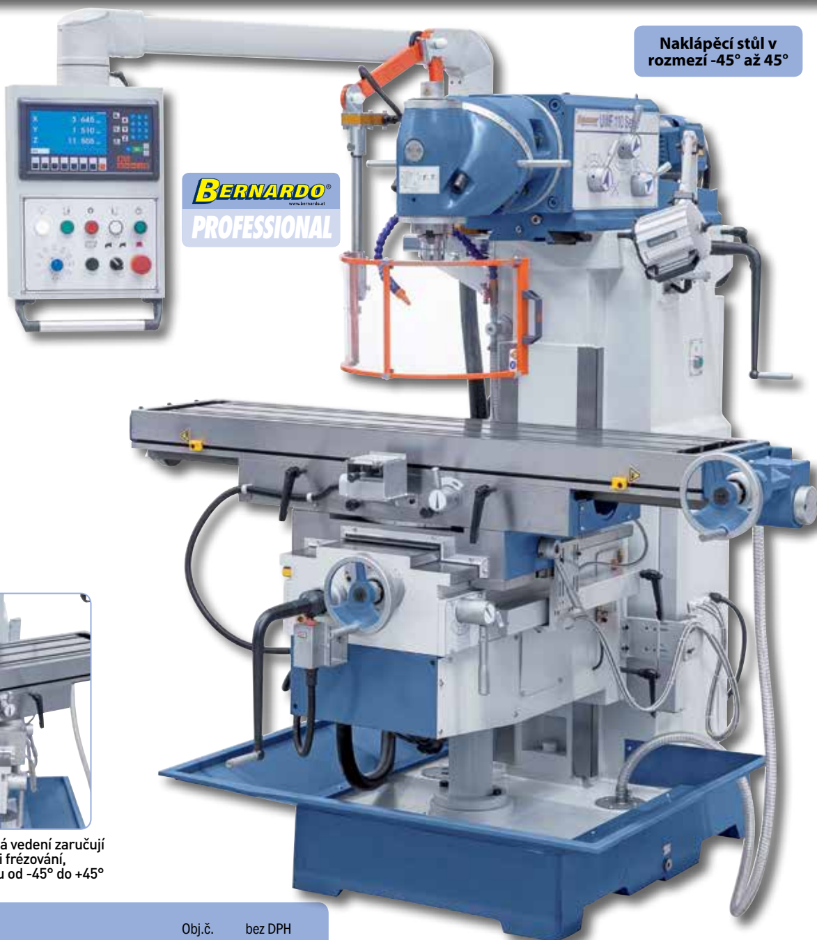
Rychlé a jednoduché nastavení požadovaných rychlostí posuvu přímo na ovládacím panelu
