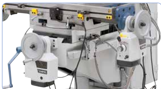
Automatický posuv frézovacího stolu pro osu x a y v základní výbavě
