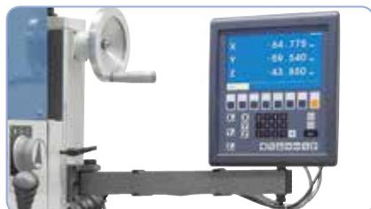
BF 30 Super s 3osým digitálním odměrováním ES-12 V s LCD displejem (Obj.č. 02-1044C)
