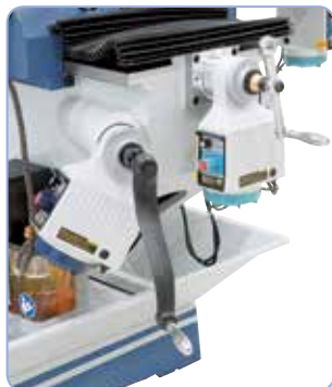
Plynulý posuv pro osu x, y, z v základní výbavě
