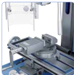
Frézování s přesným strojním svěrákem PS 75
