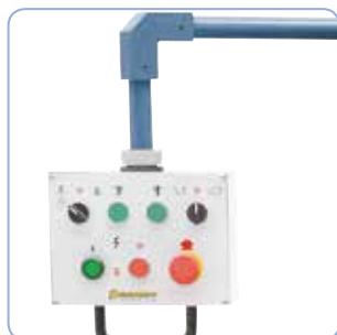
Posuvný a otočný ovládací panel s ergonomicky umístěnými ovládacími prvky
