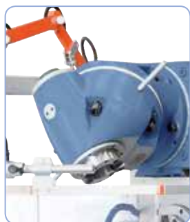
Univerzální frézovací hlava stavitelná do nejrůznějších úhlových poloh
