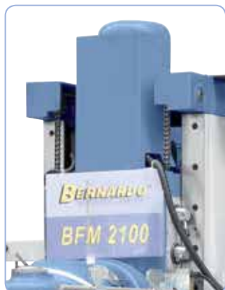
Včetně vyrovnávače hmotnosti a teleskopického krytu osy z
