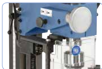
Pinola s jemným posuvem pro přesné obrábění
