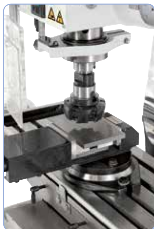
Frézování rovinou frézou (Obj.č. 42-1085)
