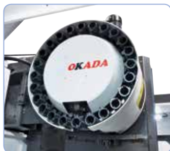
Sériově je vybaven 24-dílným výměníkem nástrojů.
