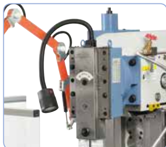
Obráběcí hlava (volitelná) s nastavitelným zdvihem umožňuje naklápění vlevo nebo vpravo.
