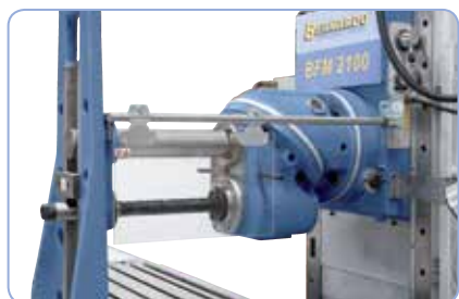
Opěrné ložisko a dlouhý frézovací trn k horizontálnímu frézování v základní výbavě
