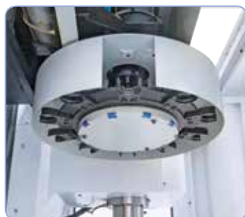
12polohový otočný nožový držák pro krátké časy přestavení
