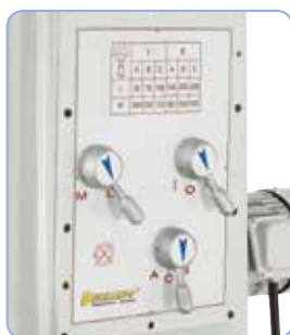
Logicky a přehledně uspořádané řazení změn otáček vřetene
