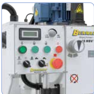
Jednoduchá předvolba stupně převodovky volicím spínačem převodovky, nastavení požadovaných otáček potenciometrem
