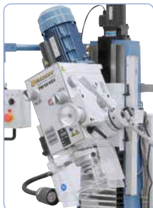
Frézovací hlava lze oboustranně naklápět v úhlu od -60° do +60°
