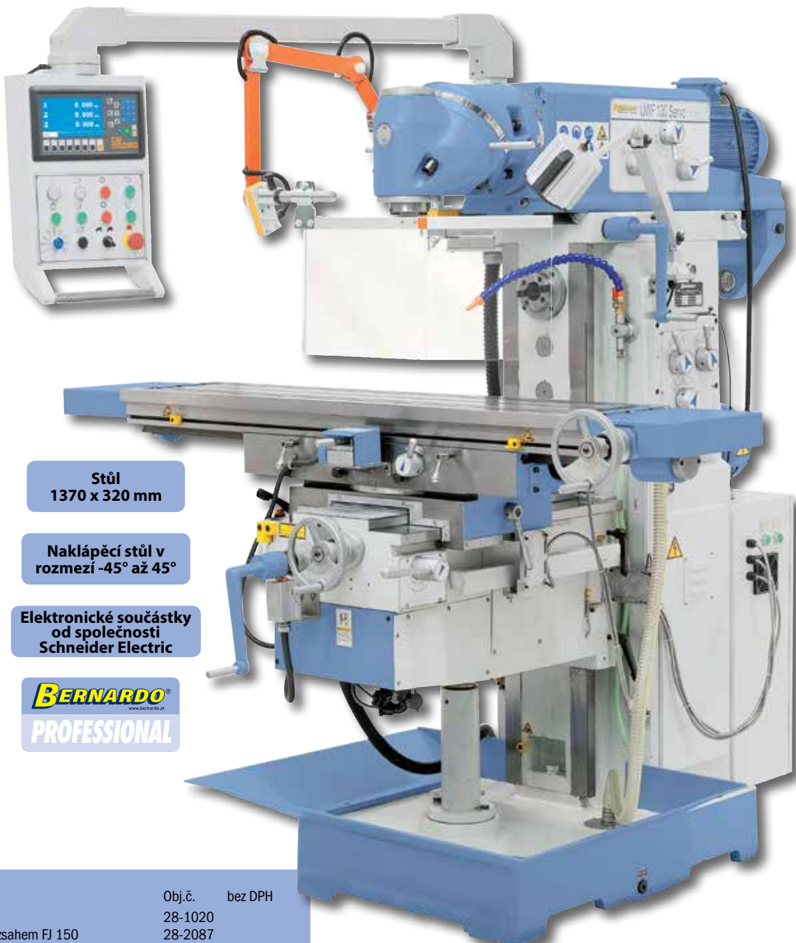
Univerzální frézovací hlava s 2 osami otáčení, stavitelná do všech poloh s libovolným úhlem
