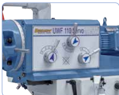
Jednoduchá obsluha ovládacích prvků pro změnu otáček
