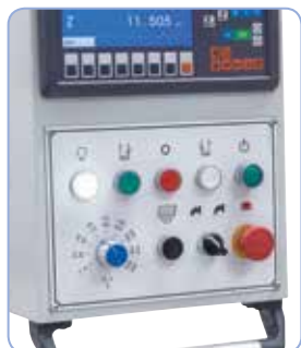
Rychlé a jednoduché nastavení požadovaných rychlostí posuvu přímo na ovládacím panelu
