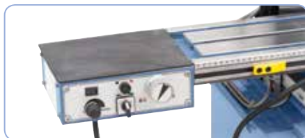
Komfort obsluhy zvyšuje sériově dodávaný, plynule regulovatelný posuv frézovacího stolu FTV 6 (Obj.č. 02-1032 / 02-1033B)
