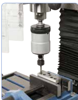
Pro řezání závitů lze objednat závitoreznou hlavu o rozsahu závitů M 5 - M 12
