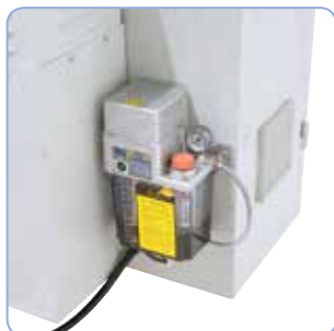
V dodávce elektrické centrální mazání
