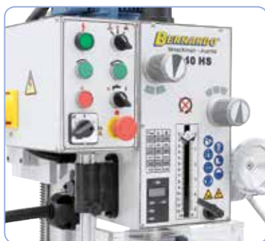
Všechny ovládací a obslužné prvky jsou přehledně umístěné na hlavě převodovky
