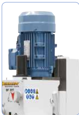
Výkonný 2stupňový hnací motor s hnací silou 0,75 / 1,1 kW.
