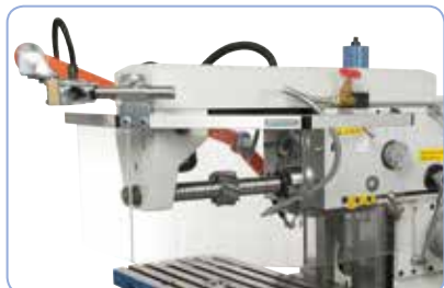
Horizontální frézování s opěrným ložiskem
