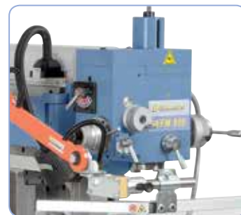
Naklápěcí vertikální frézovací hlava s 60 mm zdvihem polohy a 3-mi automatickými posuvy
