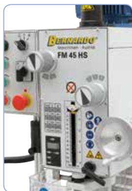
Jednoduchá a rychlá změna otáček řadičí pákou
