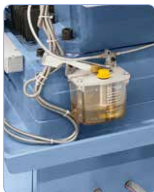
V dodávce centrální mazání všech vodičích drah
