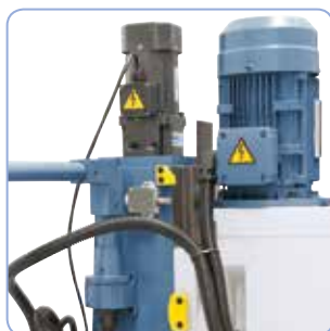
Nastavení výšky frézovací hlavy motorem zdvihu
