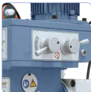
Jednoduché ovládání řadicích prvků změny otáček
