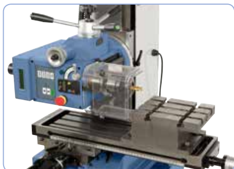
Naklápěcí frézovací hlava (v úhlu 90° P / 30° L) rozšiřuje oblast využití. Pracovní stůl ulehčuje frézování ve vodorovné poloze (na objednávku)
