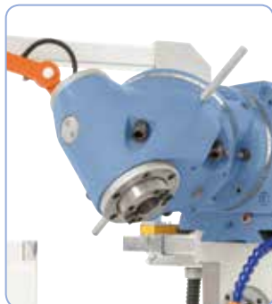
Univerzální frézovací hlava s 2 osami otáčení, stavitelná do všech poloh s libovolným úhlem
