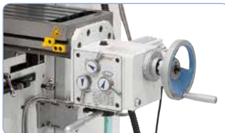
Podélný posuv stolu s rychloposuvem v základní výbavě
