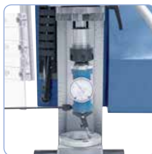
Středící 2D dotykový snímač k vyvrtávání
