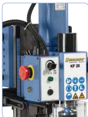
Ovládání otáček plynule nastavitelným stejnosměrným motorem
