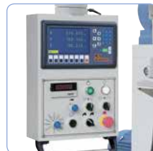
Regulace otáček vertikálního vřetene frekvenčním měničem
