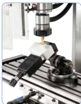
Frézování s trojosým otočným svérákem PGS 50
