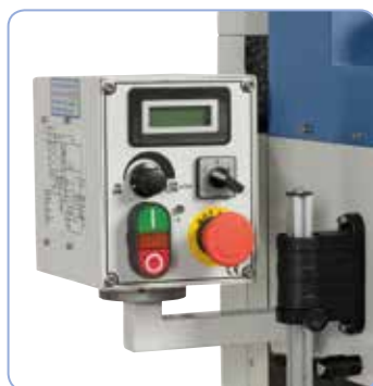
Dodáváno s digitálním ukazatelem otáček a s pravým i levým otáčením vřetene
