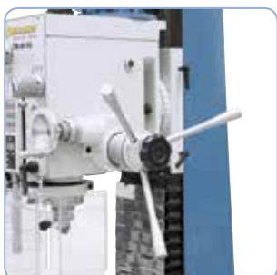
Jednoduché ovládání pinoly s vhodně umístěnými ručními ovladači, na ručních ovládacích kolech je stupnice k přesnému nastavení parametrů frézování.
