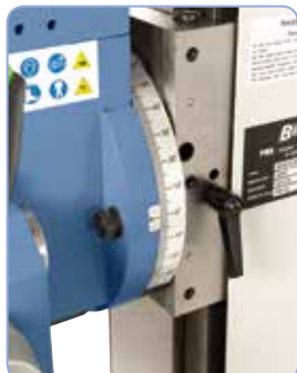
Bezúdržbové rybinové vedení s nastavitelnými klínovými zarážkami
