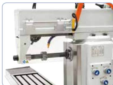
Horizontální vřeteno nabízí rozšířené možnosti využití, regulace otáček pomocí řazení převodů
