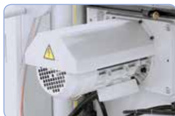
Polohovací motor k nastavení výšky stolu v ose z
