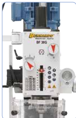
Nastavitelný hloubkový doraz s přehlednou stupnicí pro odečítání hloubky vrtání
