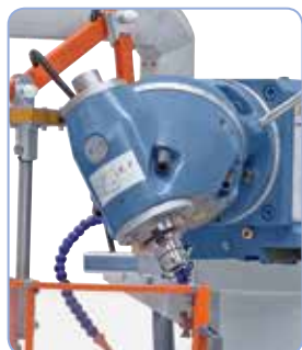
Univerzální frézovací hlava, stavitelná do všech poloh s libovolným úhlem
