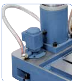
Čerpadlo chladicí kapaliny v základní výbavě
