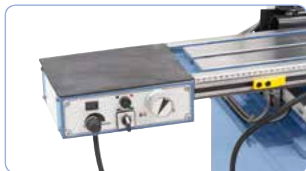
Plynule nastavitelný posuv stolu pro větší komfort
