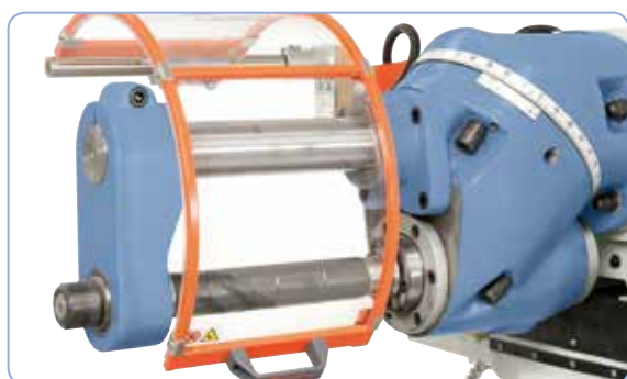
Opěrné ložisko a dlouhý frézovací trn k horizontálnímu frézování v základní výbavě
