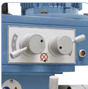
Jednoduché ovládání radících prvků změny otáček
