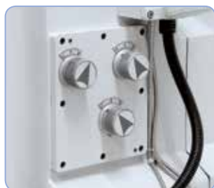
Jednoduché řazení převodů pohonu horizontálního vřetene v základní výbavě
