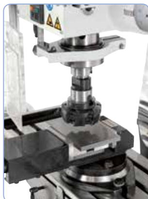
Frézování rovinnou frézou (Obj.č. 42-1085)
