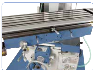
Dostatečně dimenzovaná rovinná vedení zaručují stabilitu při vysokém zatížení při frézování, frézovací stůl lze naklápět v úhlu od -45° do +45°
