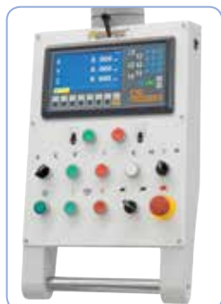
Přehledný a otočný ovládací elektropanel. Digitální odměřování v základní výbavě
