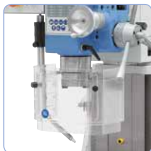
Vysoká bezpečnost zajištěna výškově stavitelným krytem sklíčka s mikrosínačem
