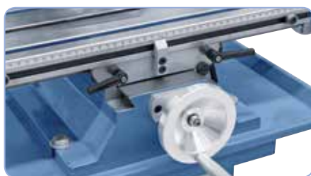
Rybinové vedení v osách x, y, z, seřiditelné prostřednictvím klínových lišt
