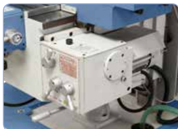
Využíváním posuvu stolu s funkcí rychloposuvu ve všech 3 osách lze podstatně snižovat ztráty času při výrobě
