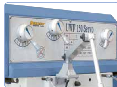
Jednoduché ovládání spínacích prvků pro změnu otáček
