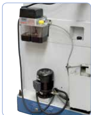
Elektrické centrální mazání a chladicí systém v základní výbavě
